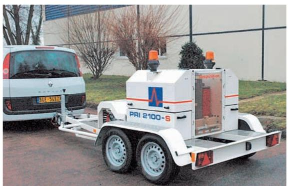
Remorque de mesure de déflexion de type HWD
