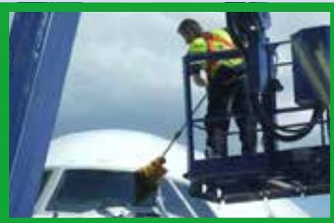
Lors de l'utilisation d'un tel équipement, il convient d'être vigilant à la proximité de l'aéronef afin de ne pas l'endommager, en particulier aux nombreuses sondes disposées autour du pare-brise.
