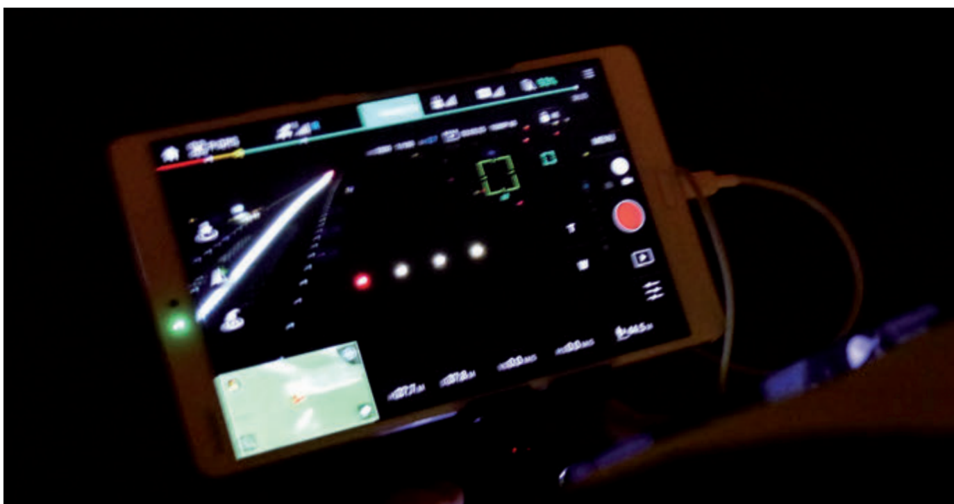
Figure 68: Visualisation en temps réel des unités lumineuses d'un dispositif PAPI à l'aide d'un drone.
