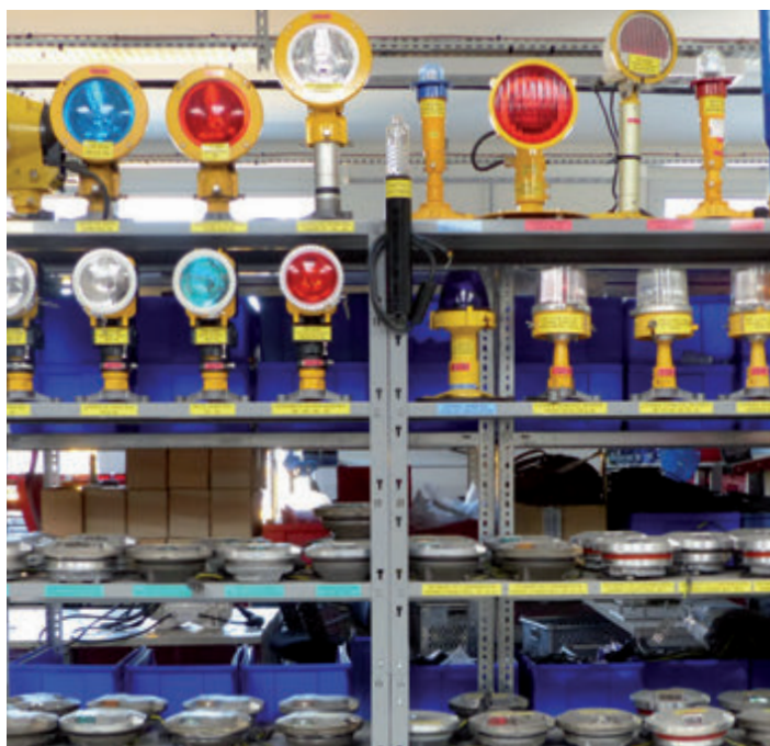
Figure 33: Exemples de feux de balisage lumineux d'aérodrome.
