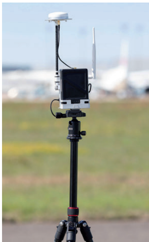
Figure 70: Station RTK positionnée au seuil de piste pour la mesure de l'angle de calage en site des unités lumineuses d'un dispositif PAPI par la méthode du drone - Aéroport de Toulouse Blagnac.
