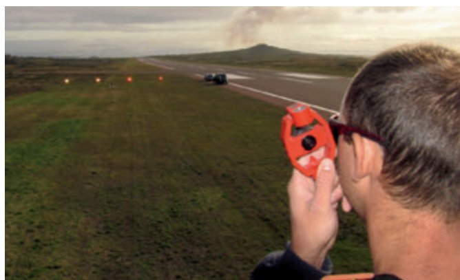
Figure 65 : Observateur dans une nacelle tenant un prisme de visée pour la mesure de l'angle de calage en site d'une unité lumineuse d'un dispositif PAPI.
