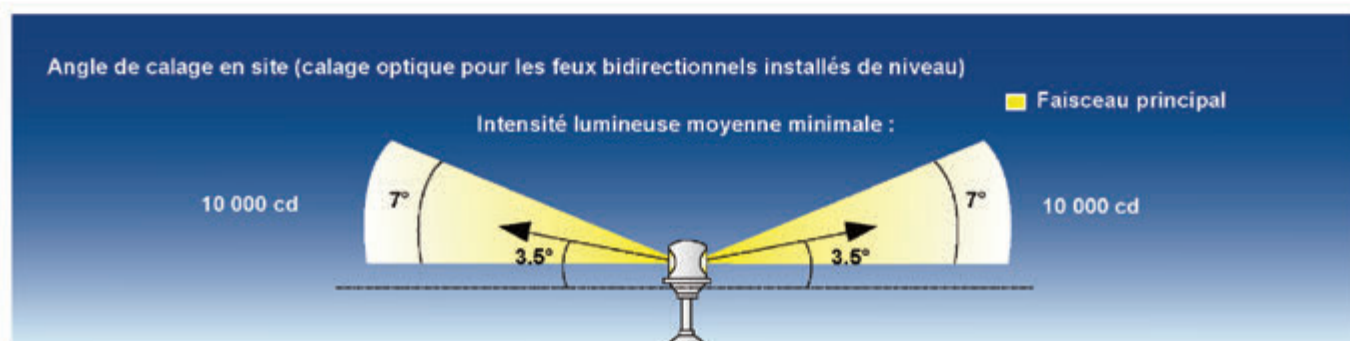
Figure 60: Angles de calage en azimut et en site requis pour les feux de bord de piste.
