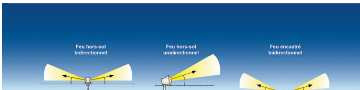
Figure 54: Angle de calage vertical (ou en site) de feux de bord de piste (vue de profil).
