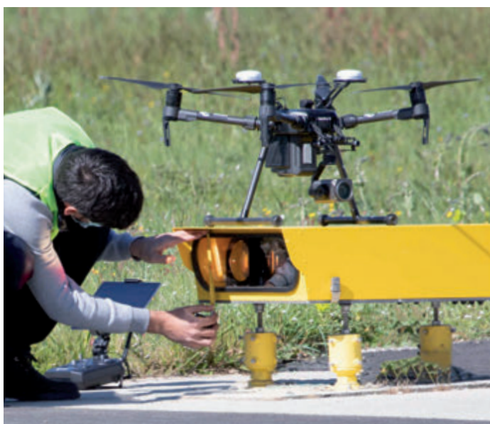
Figure 69: Prise en compte de la position de l'antenne GPS pour la mesure de l'angle de calage en site d'une unité lumineuse d'un dispositif PAPI par la méthode du drone – Aéroport de Toulouse Blagnac.
