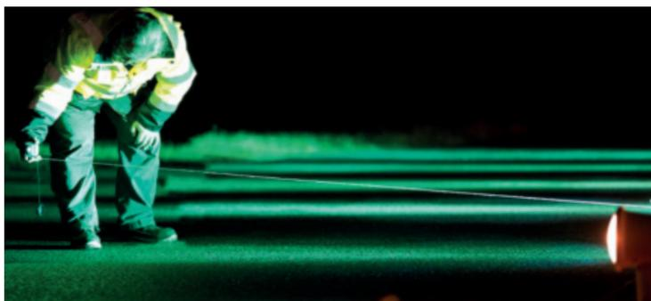
Figure 41 : Mesure photométrique sur site d'un feu de seuil de piste réalisée manuellement.
