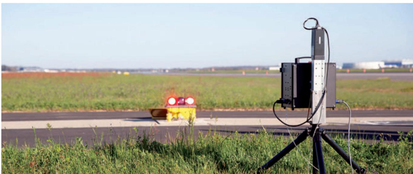
Figure 72: Mesure de l'angle de calage en site d'une unité lumineuse d'un dispositif PAPI par la méthode de mesure au sol – Aéroport de Toulouse Blagnac.
