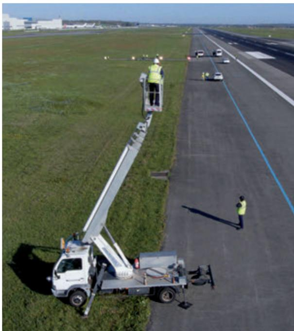
Figure 64 : Nacelle positionnée pour la mesure de l'angle de calage en site d'une unité lumineuse d'un dispositif PAPI - Aéroport de Toulouse Blagnac.
