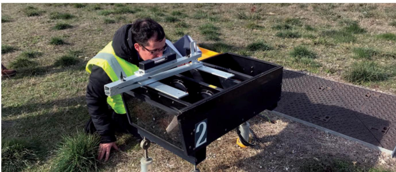
Figure 47 : Contrôle du calage en site d'une unité lumineuse d'un dispositif PAPI – Aérodrome d'Avignon.
