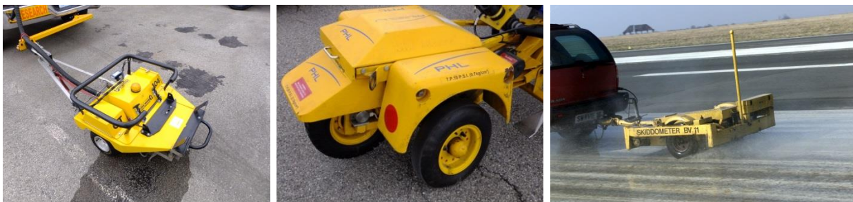
Figure 2-19 : Différents appareils de mesure du frottement (de gauche à droite) : le Griptester, le Mu-Meter et le Skiddometer BV-11
