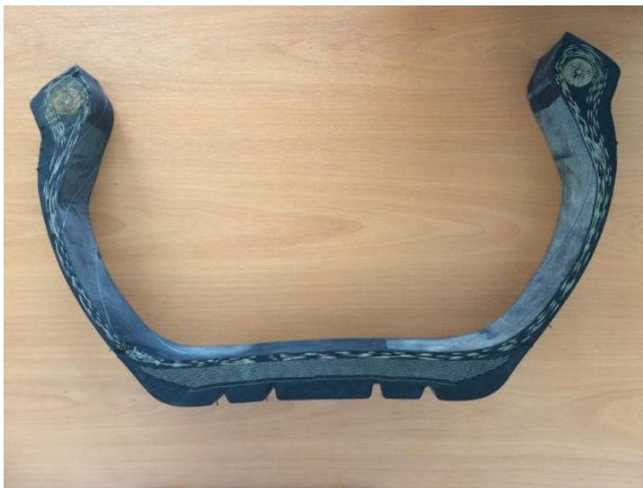
Figure 4-18 : Photographie et représentation schématique d'une coupe de pneumatique
