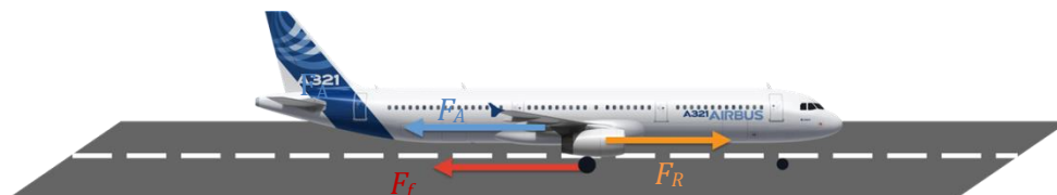
Figure 7-6 : Bilan des forces s'exerçant sur l'avion lors du freinage (d'après [Gerthoffert, 2015])
