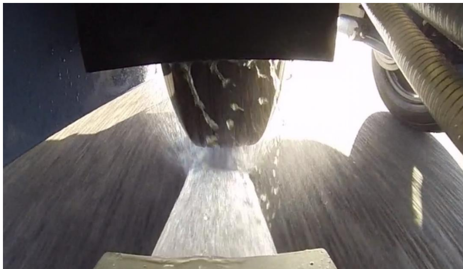
Figure 5-14 : Mouillage artificiel avec l'IMAG
