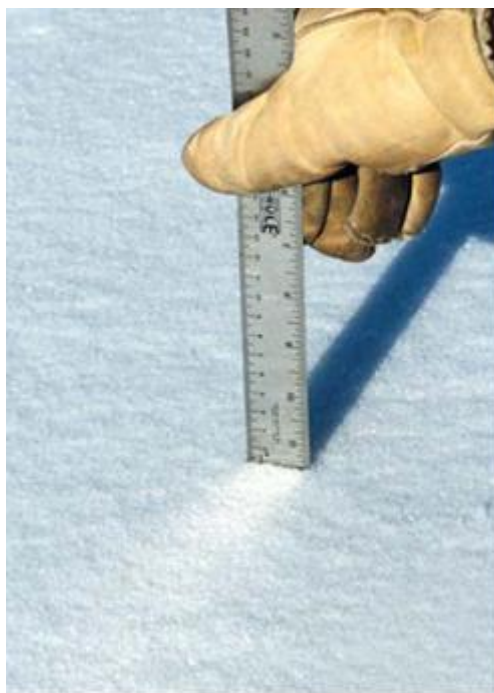
Figure 2-21 : Mesure de la hauteur de neige à l'aide d'une règle graduée [Deffieux, 2014]
