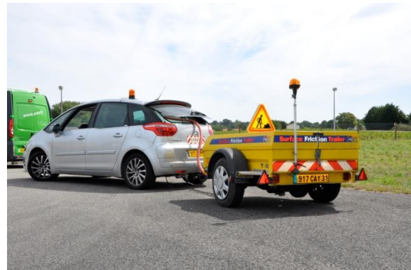
Figure 2-12 : Deux appareils de mesure continue du frottement, l'IMAG et le SARSYS STFT
