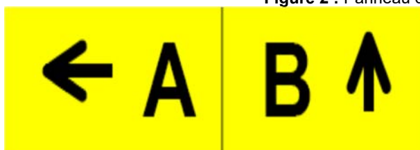
Figure 3 : Panneau indicateur de la direction des voies de circulation A et B
