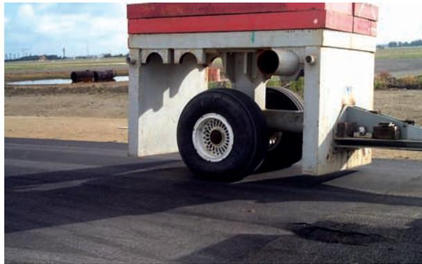
*Roulage module 2 roues sur section type 1 bis*
