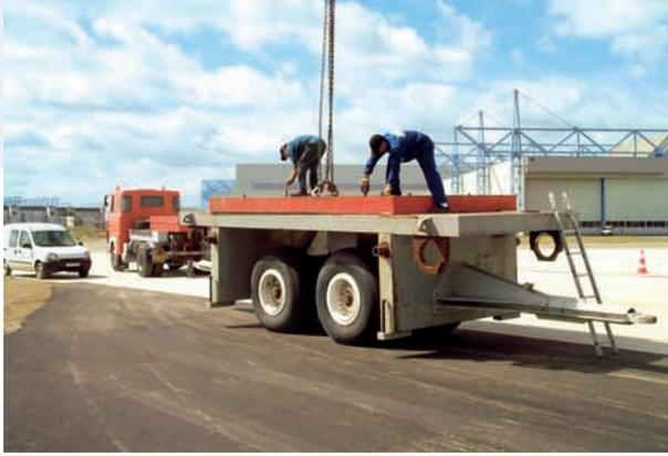
Mise en place et chargement du module 4 roues
