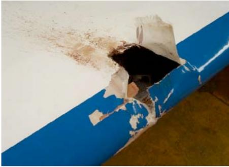
Le 11 mai 2002 un Robin en croisière à 100 kts percute un oiseau qui défonce profondément l'aile gauche de l'avion contraignant le pilote à un atterrissage de prudence. La collecte des restes permettra d'identifier une Buse variable d'un kilogramme (photo 6).
