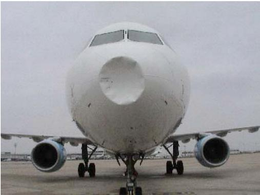
Photo 1 : Un radôme endommagé après une collision avec un Vanneau huppé.
