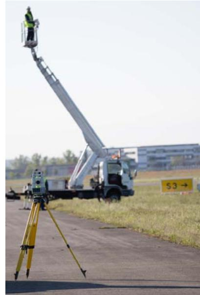
La nacelle est positionnée à environ 150 m du PAPI respectivement dans l'axe de chaque unité (A, B, C et D). La hauteur de mesure est ajustée par le conducteur de la nacelle afin que l'observateur (dans la nacelle) puisse regarder le faisceau blanc de l'unité lumineuse en position debout standard et le faisceau rouge en position jambes fléchies. La zone de transition colorimétrique est ensuite évaluée par l'observateur par simple fléchissement des jambes.
