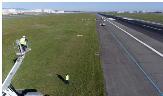
Le géomètre détermine la position du théodolite en fonction de ses caractéristiques, et de la position des lentilles des unités de PAPI à mesurer. L'observateur tient un prisme de visée à hauteur de ses yeux. Le géomètre suit les déplacements verticaux de l'observateur en pointant le prisme de visée. Les mesures angulaires sont relevées lorsque l'observateur repère la zone de transition colorimétrique qui correspond aux passages du rouge au blanc et du blanc au rouge.
