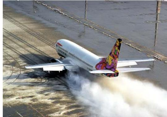
Test d'atterrissage d'un B737 sur piste verglacée à Munich
