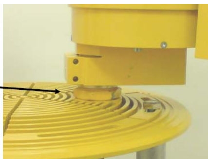
Figure 59 : Positionnement de la bague cassante (source Xsight)
