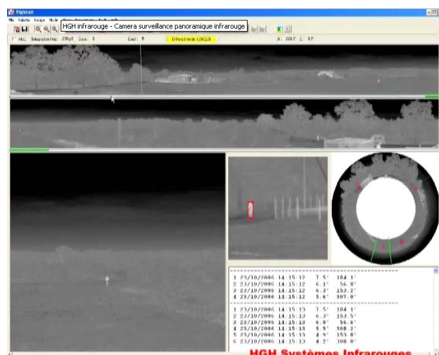
Figure 65 : Détection d'intrusion en vision panoramique infrarouge
