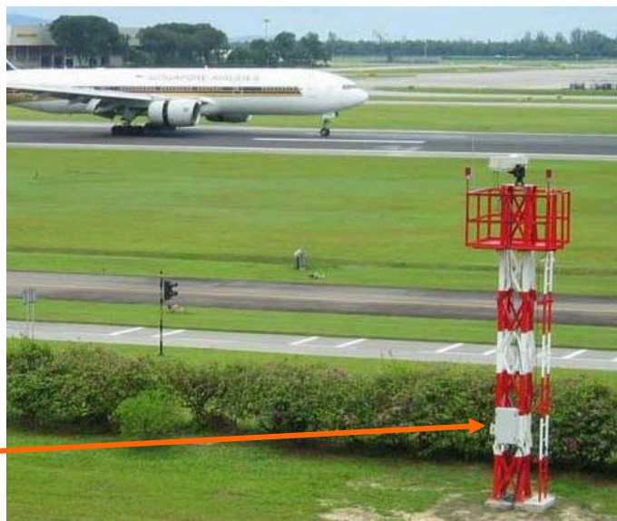
Figure 48 : Détecteur caméra sur pylône en treillis (source Stratech)
