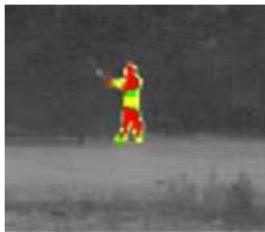
Figure 66 : A gauche, une alarme est déclenchée par la présence d'une personne dans une zone de détection. A gauche, image thermique d'une personne détecté par le système
