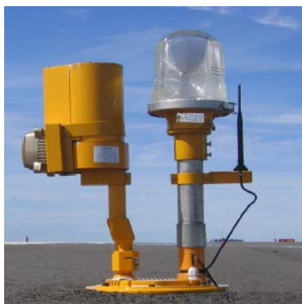
Figure 57 : Détecteur combiné radar + caméra (source Xsight)
