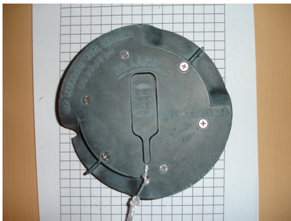
Figure 2 : Bouchon de réservoir d'avion (source ADP)
