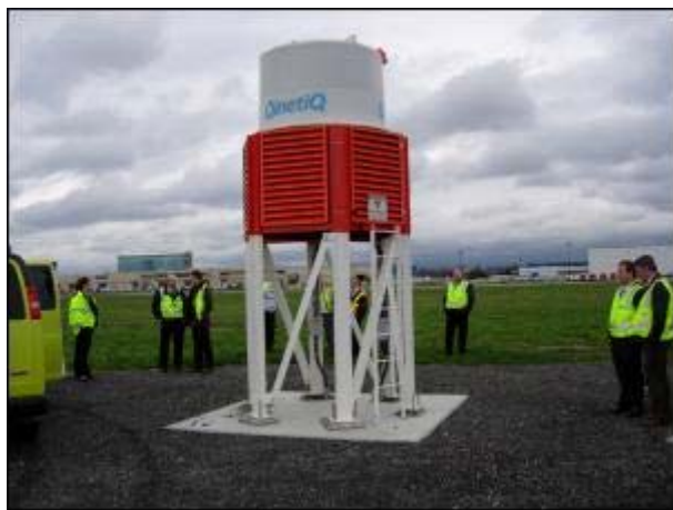
Figure 35 : Le pylône et l'unité associée (source STAC)
