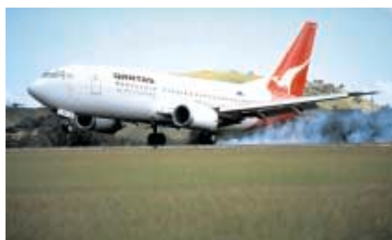
Aéroport de Nouméa-La-Tontouta : toucher de roues entraînant un dépôt de gomme
