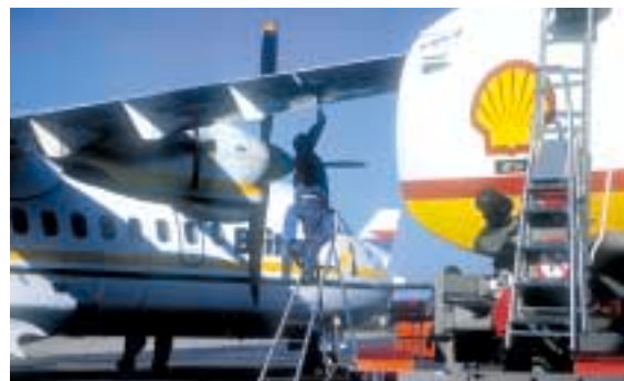
Aéroport de Strasbourg-Entzheim : avitaillement d'un ATR42 par camion citerne
