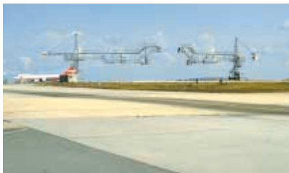
Portiques utilisés sur l'aéroport de Roissy-Charles-De-Gaulle pour le dégivrage des avions
