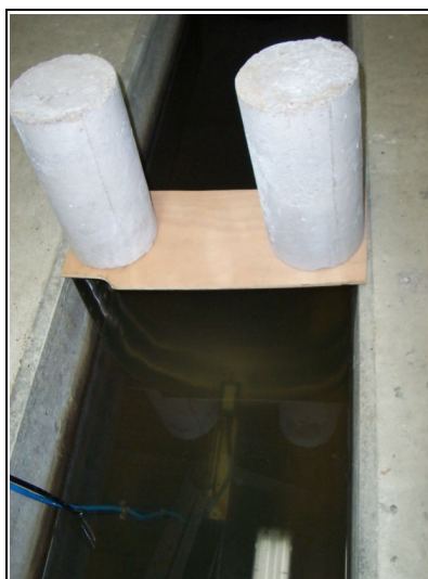
Figure 9: Implantation du débitmètre à effet doppler
