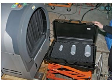
Caractérisation d'explosifs à l'aide d'un appareil tomographique (rayons X)
