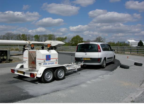
Le HWD (Heavy Weight Deflectometer) est un appareil d'auscultation non destructive des chaussées aéronautiques permettant d'engendrer, par un système de masse tombante, un chargement de type impulsif, afin de simuler le passage d'une roue d'avion. La réponse de la chaussée à cette sollicitation est mesurée au moyen de géophones, un capteur de force intégré à la plaque de chargement permet de suivre l'effort appliqué au cours de l'essai.
