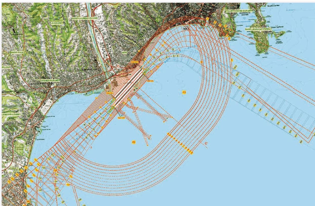
Figure 47: Exemple de suppression d'une partie des surfaces de base - Projet de PSA de Nice Côte d'Azur.
