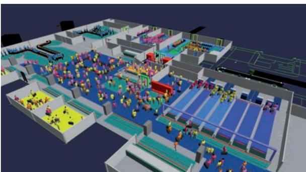
Figure 7: Modélisation d'une aérogare et de ses différentes fonctions à l'aide d'un logiciel de simulation
