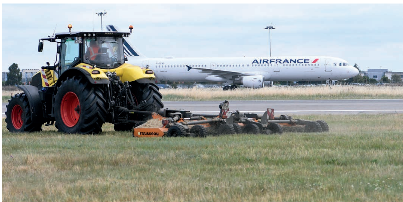
Figure 22 – Faucheuse broyeuse en action sur une plateforme.
