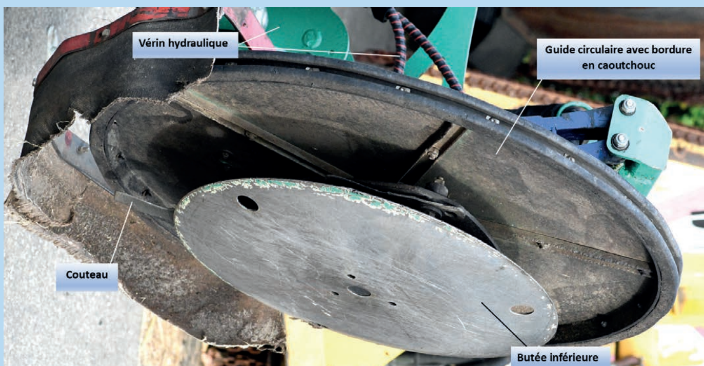
Figure 32 – Faucheuse à couteaux pour clôtures, montée sur vérin hydraulique.
