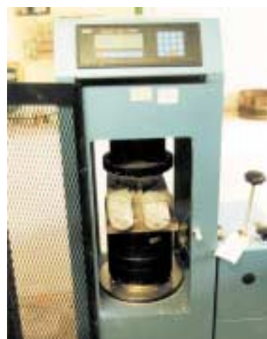
Essai de traction par fendage
