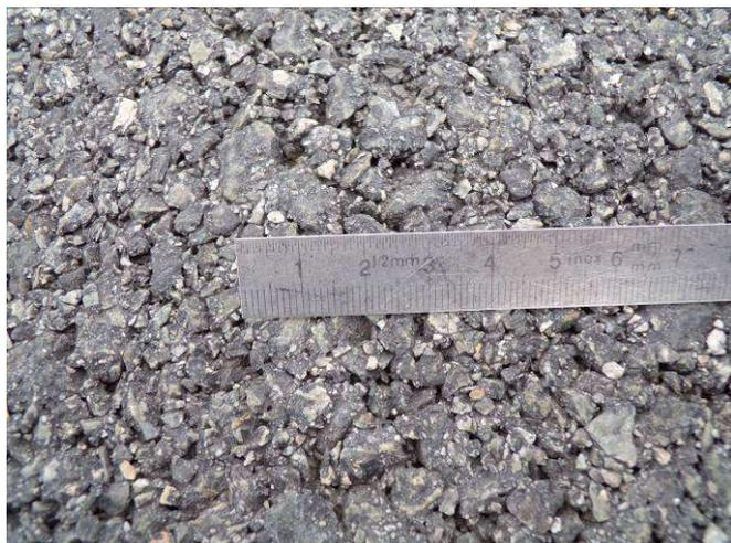
Surface E1: Béton bitumineux semi-grenu (0/10)
