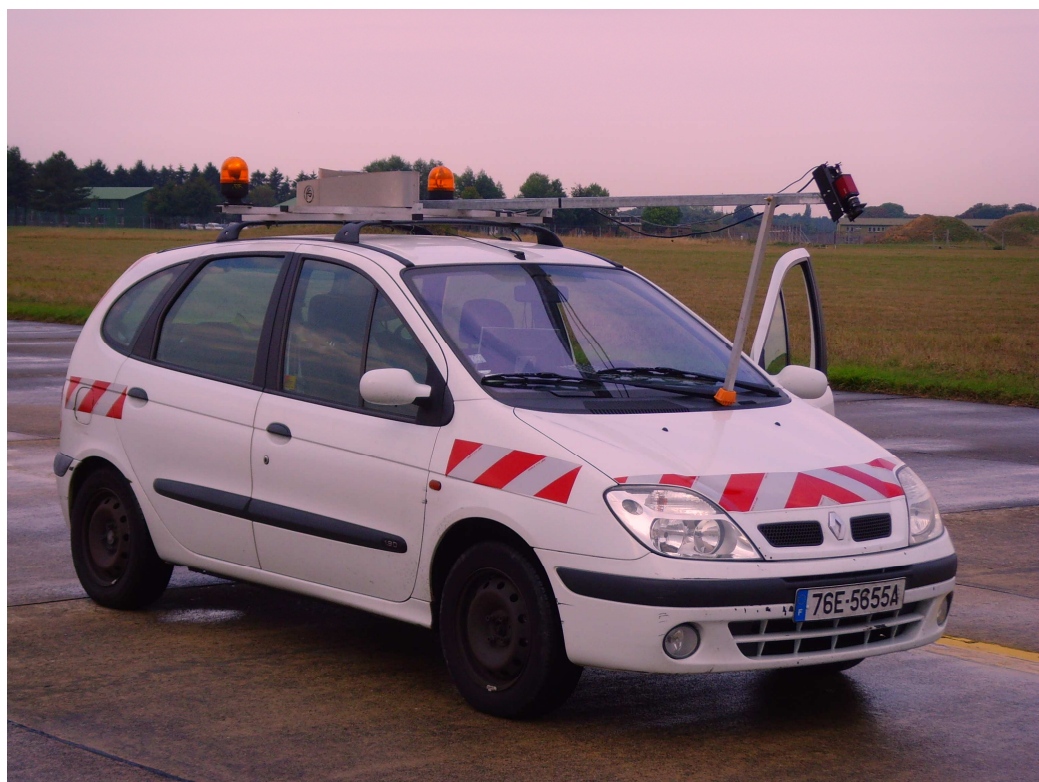
Véhicule IRCAN : la caméra est ici dirigée vers la chaussée.
