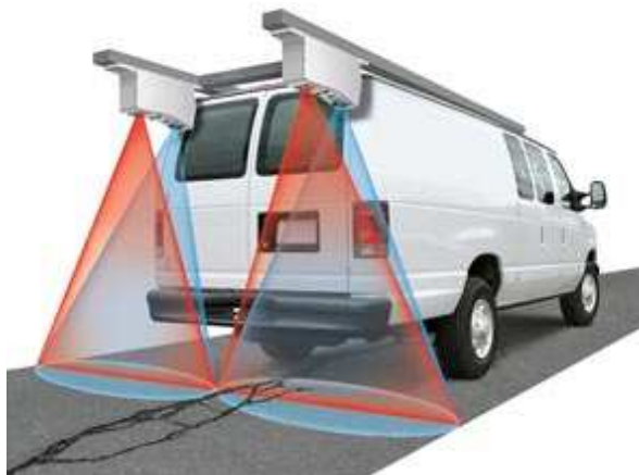
Illustration du système INO LCMS.
