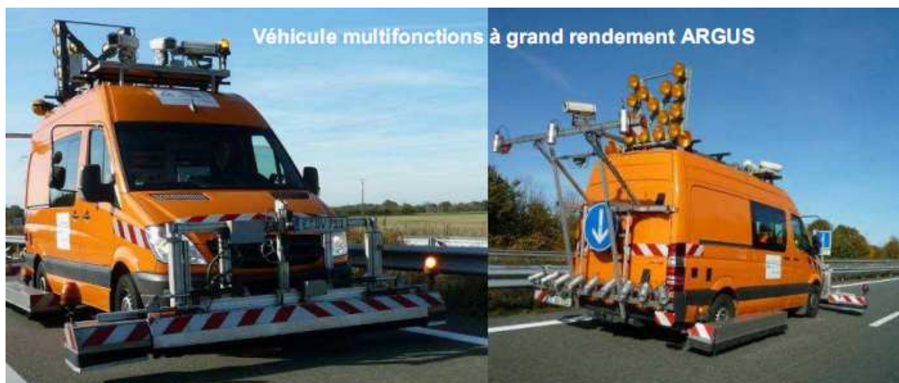
Le véhicule Argus : à l'avant, le profilomètre laser. A l'arrière, les caméras haute résolution.
