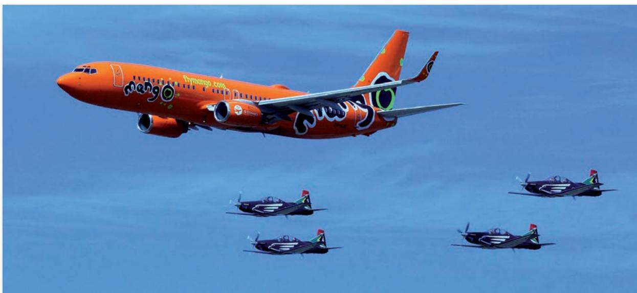
Différentes catégories d'avions relatives à la turbulence de sillage selon leurs masses et envergures (au-dessus, un B737-800 (M, CAT D), en dessous, quatre Pilatus PC-7 (L, CAT F).
