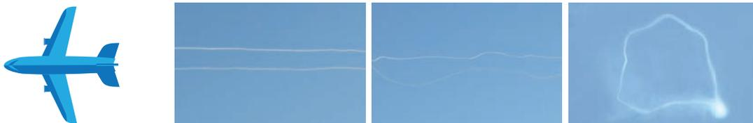
Figure 6 : Visualisation par fumigènes des 3 stades d'évolution temporelle de la turbulence de sillage, illustration de l'instabilité de Crow: tubes parallèles, déformations sinusoïdales, anneaux.
