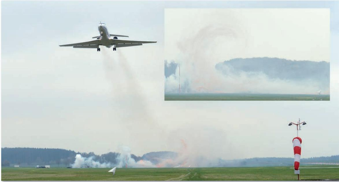
Visualisation par fumigènes des tourbillons de sillage en formation générés par le G550 du DLR.
