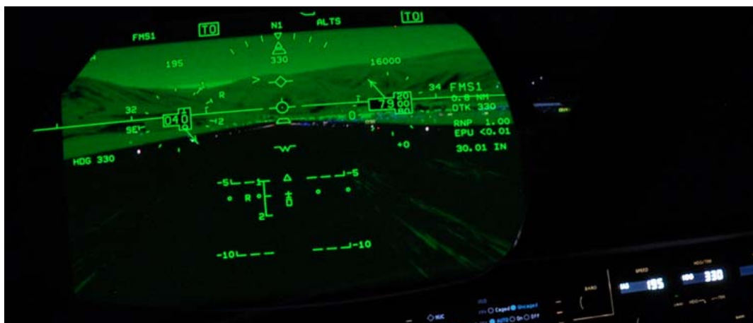
Exemple d'EFVS basé sur l'utilisation d'un affichage tête haute et d'une caméra infra-rouge
