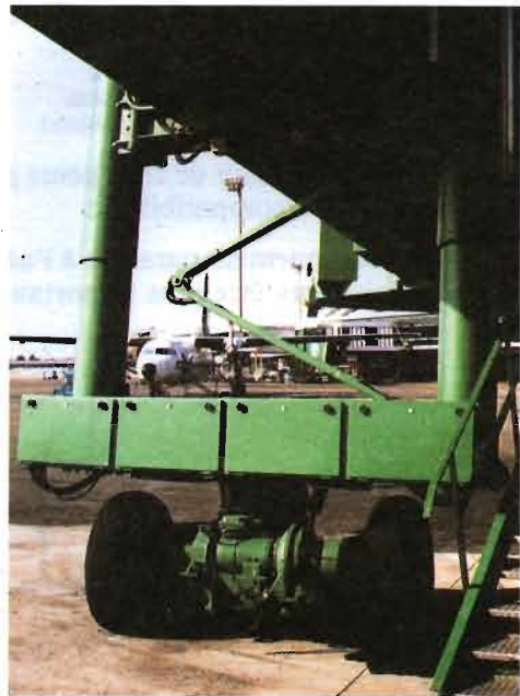
◀ Pour réduire ce poinçonnement une solution consiste à multiplier le nombre de roues. Passerelles de Toulouse-Blagnac.
