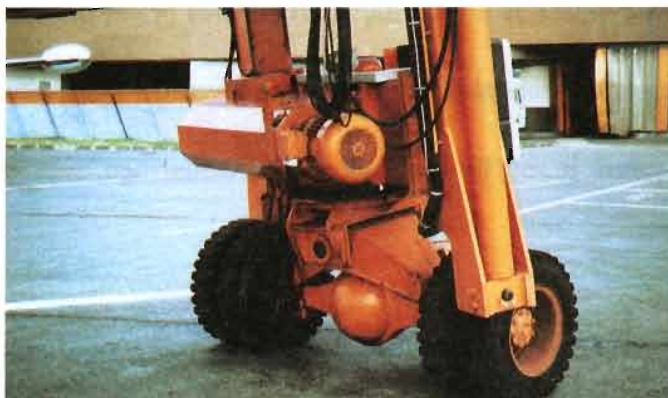
◀ Pour réduire ce poinçonnement une solution consiste à multiplier le nombre de roues. Passerelles de Toulouse-Blagnac.
