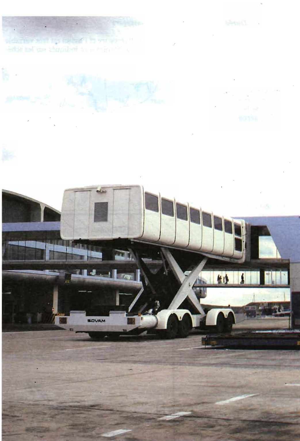
Bus élévateur à Paris CDG Aérogare n° 2.
