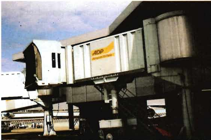
▶ Passerelle mobile et télescopique à 2 galeries à Lyon Satolas
