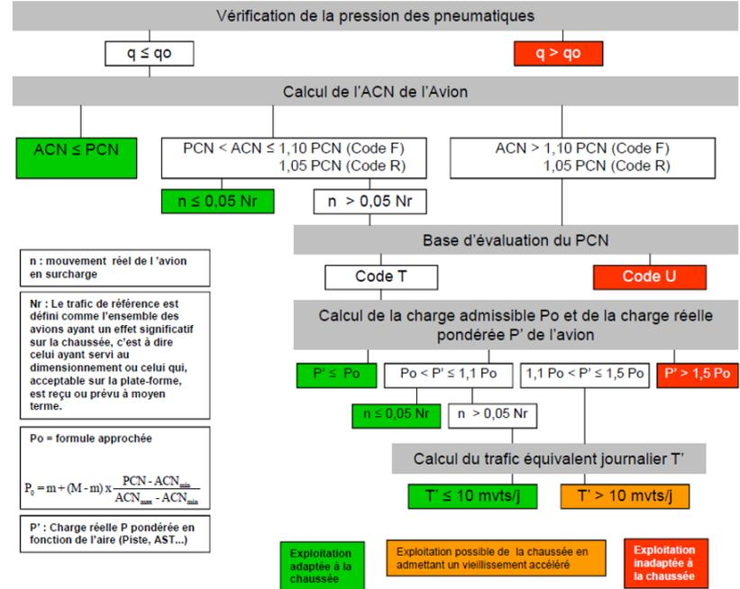
$n$  : mouvement réel de l'avion en surcharge
