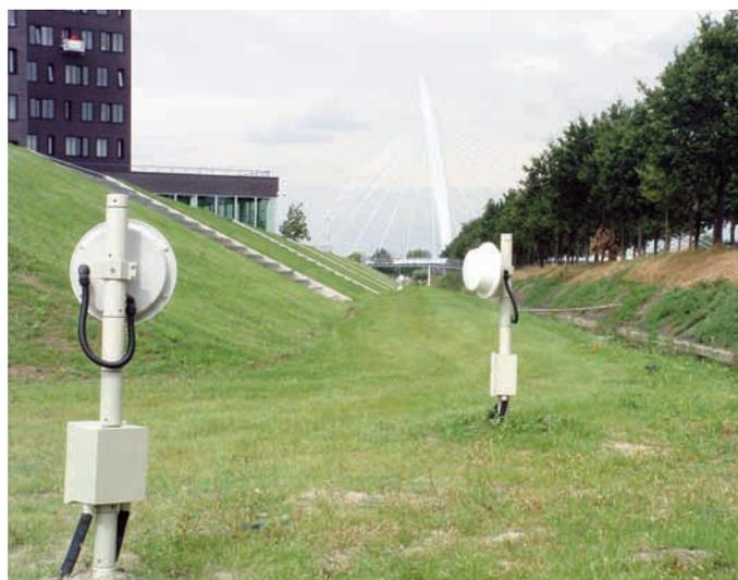
Système de détection à hyperfréquence composé d'un émetteur et d'un récepteur
