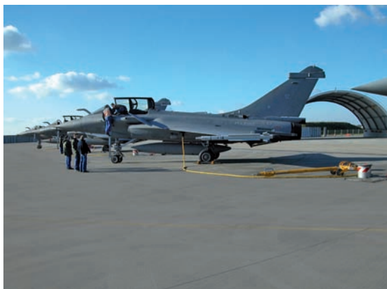
Rafale connecté à une borne escamotable d'alimentation en 400 Hz
