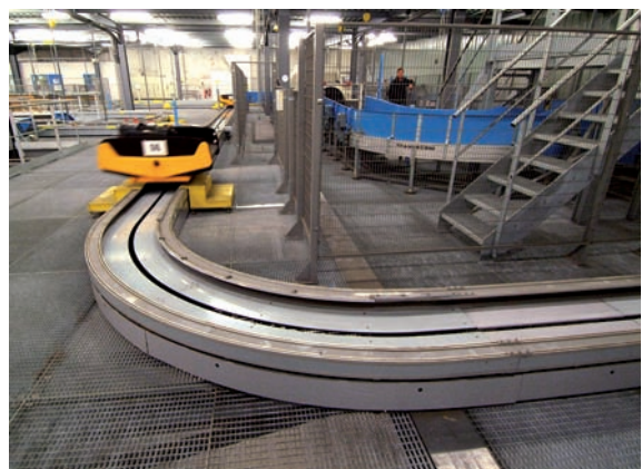
Le TBE de Roissy et ses bacs de convoyage des bagages
