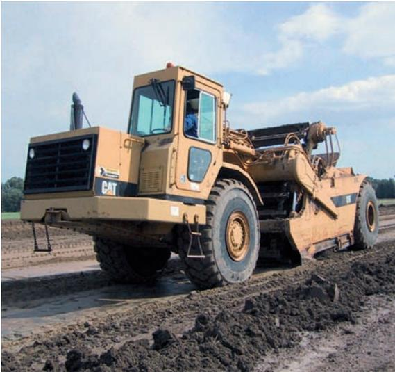
Décapeuse autochargeuse d'une ESBA du STAC
