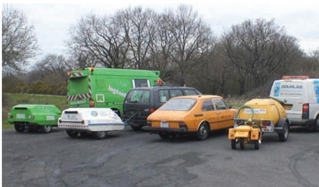
Appareils de mesure de l'adhérence participant aux essais réalisés au LCPC en mars 2008
