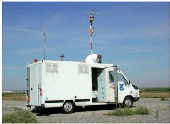
Véhicule laboratoire du STAC utilisé pour les mesures de la pollution atmosphérique
