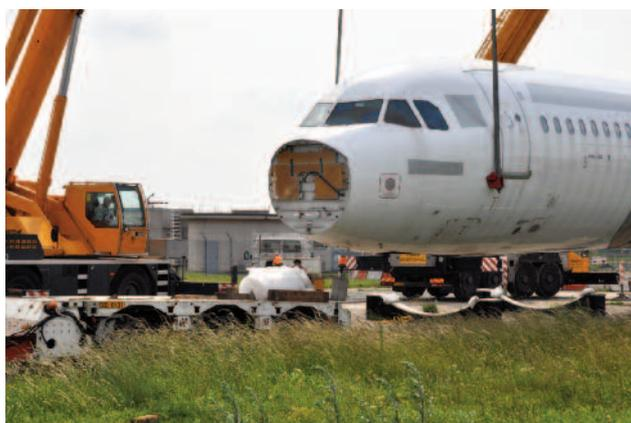
Conditionnement de la cellule d'A320 utilisée pour les tests
