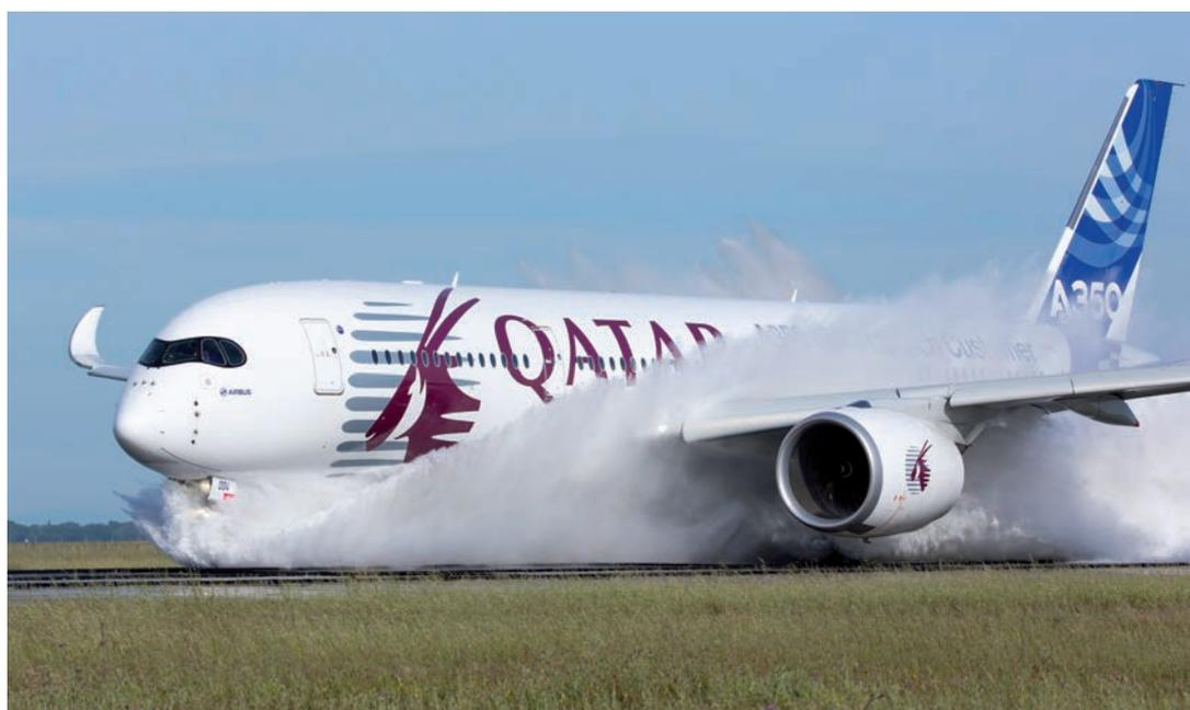
Essai de certification de l'Airbus A350 sur la base aérienne d'Istres
