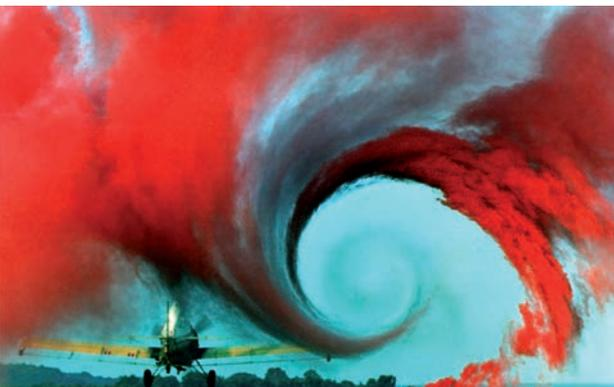
Visualisation à l'aide de fumigènes de la turbulence de sillage d'un avion de travail agricole
