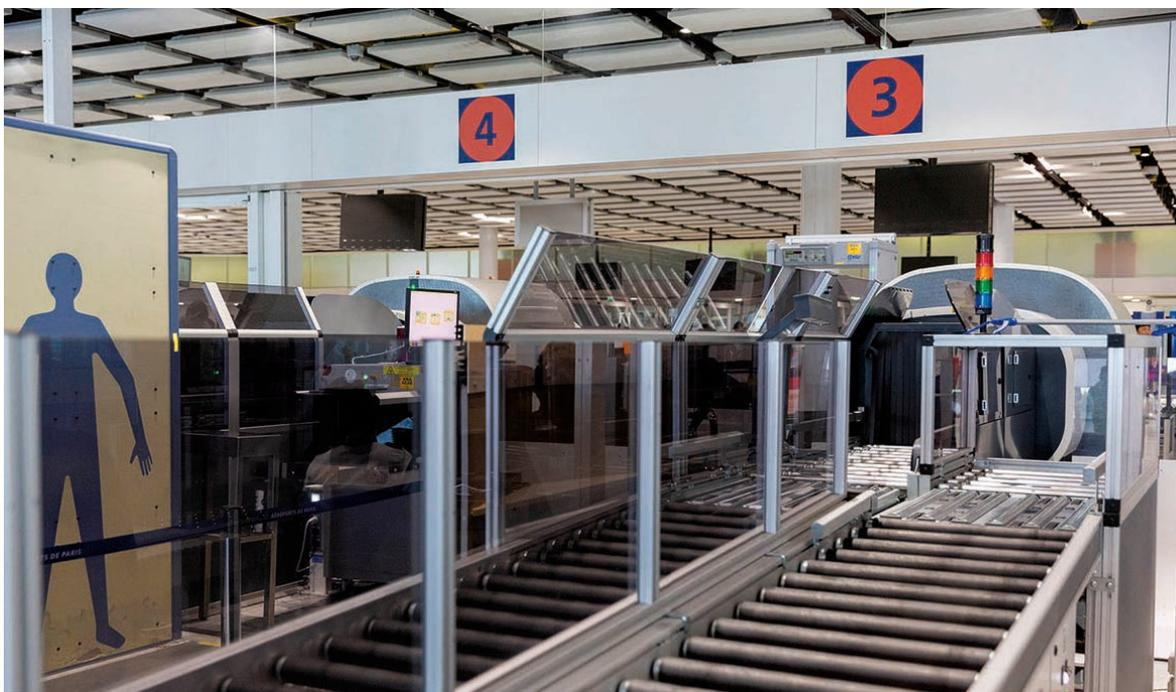
L'aéroport Roissy-Charles de Gaulle a ainsi accueilli une expérimentation en plusieurs phases d'équipements de détection d'explosifs, dits « EDS », de norme C3, utilisés pour l'inspection filtrage des bagages de cabine. Tout en permettant la détection automatique d'explosifs, les EDS cabines de norme C3 offrent aux passagers le confort de conserver leurs ordinateurs portables et liquides à l'intérieur de leurs bagages de cabine.
