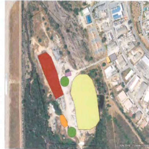
Figure 2. Localisation du site d'exploitation : en vert clair la plateforme de compostage, en rouge la zone de broyage, de criblage et stockage des matériaux internes de déconstruction (source : Balagne Recyclage).
