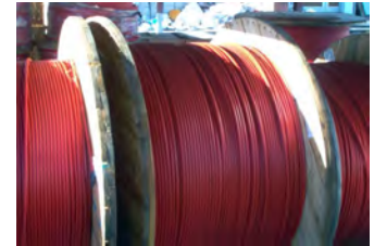
Câbles unipolaire boucles primaires
