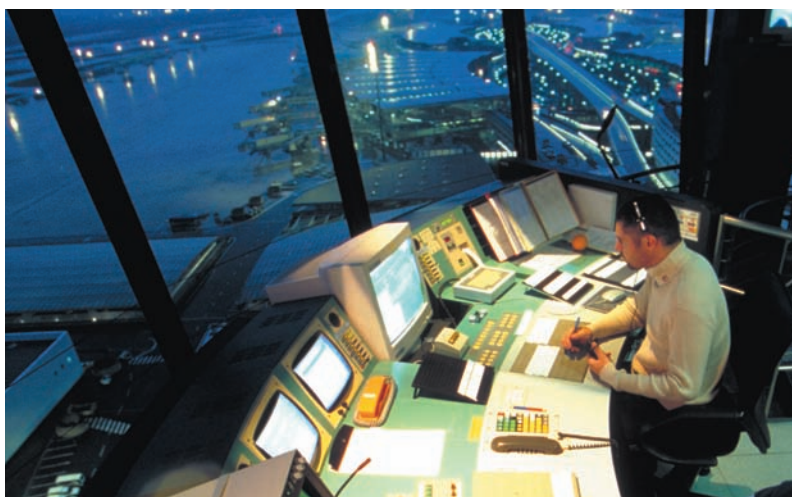
8 La couleur des vitrages de vigie doit permettre de conserver une bonne vitalité par toutes sortes de conditions extérieures, tant diurnes que nocturnes - PARIS-CHARLES-DE-GAULLE
