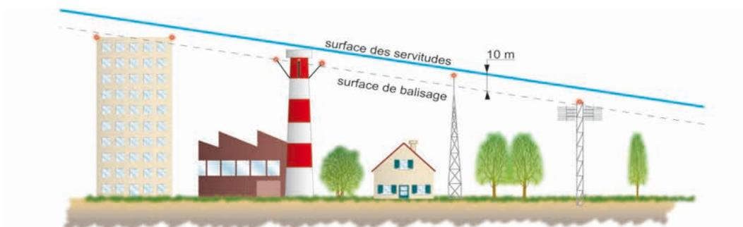
Figure 48 : Surface de balisage des obstacles massifs et minces.
