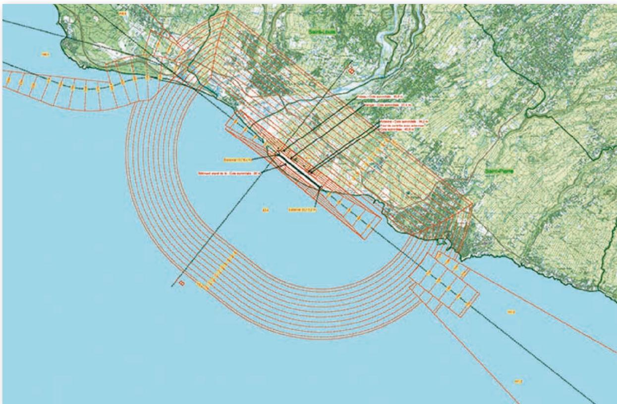
Figure 46 : Exemple de suppression d'une partie des surfaces de base – PSA de St-Pierre – Pierrefonds.
