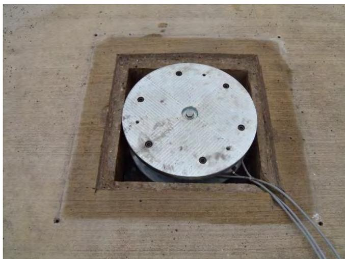
Figure 20 – Système de pesage dynamique du STAC, a) en configuration essais, b) sans la plaque supérieure
