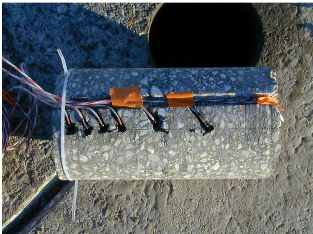
Figure 14 – Mise en place des sondes Pt100 dans l'éprouvette
